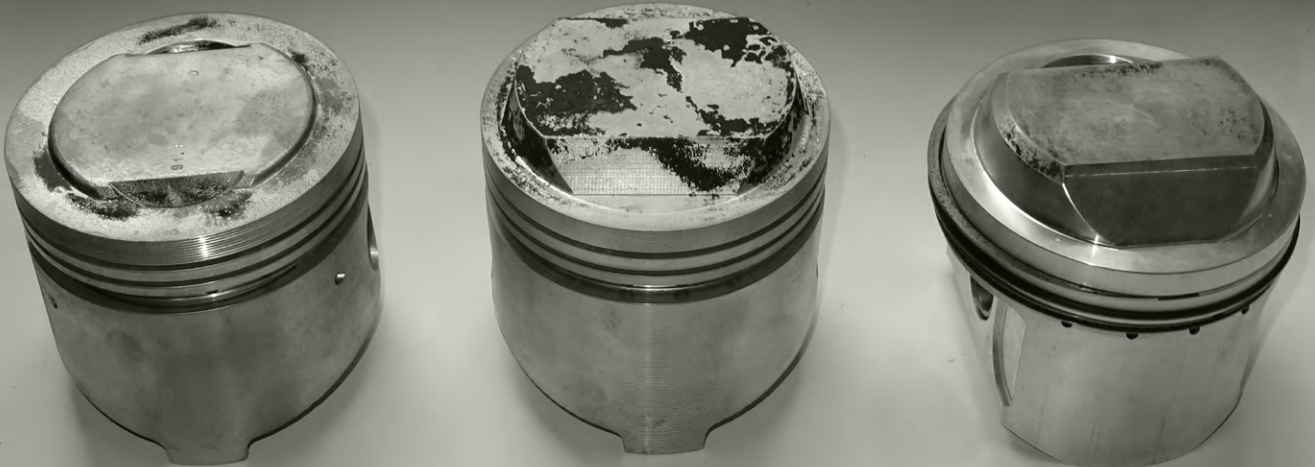
Zuiger 3 liter en Merak 3000, zuiger van 210 pk SS motor en rechts speciale zuiger voor Merak SS motor met verhoogde compressie.
