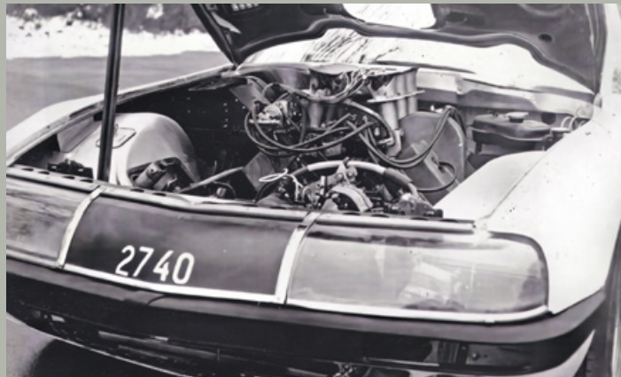
Jacques Né bouwde de witte 300km/h SM met de 24-kleppermotor die tot 380 pk kon leveren.
