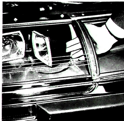
Alb. 33 - Het met de hand verdraaien van de draaibare koplamp
