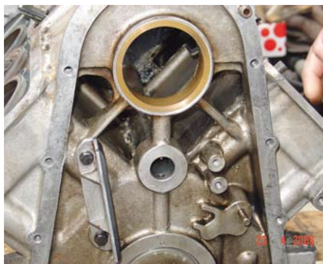
En hier: wel een bronzen lagerbus, maar geen oliekat. Dat is er wel, maar niet op de foto te zien omdat de bus is verdraaid. Dus ook geen smering!
