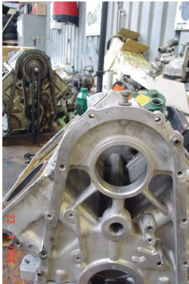
Hier kun je duidelijk zien waar het oliekanaal uitkomt in het lagergat zonder bronzen bus
